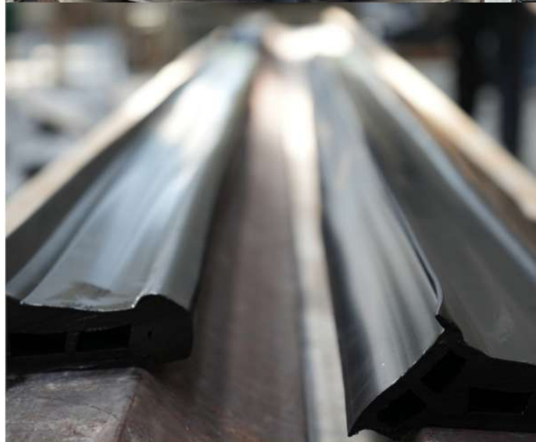
Profil extrudé en longueur avant cuisson
